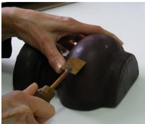
234. kép A borítás simítása száradás után meleg fémeszközzel, Fotó: DE
