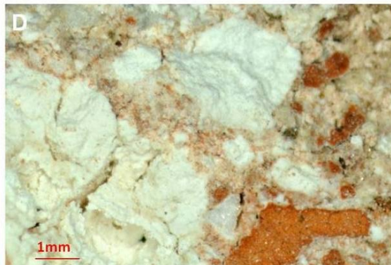
34. kép Mészcsozók mozaikpadlók nucleus rétegében. A-B: Aquincum, Helytartói palota, 8. sz. terem küszöbmozaikja, Kr. u. 3. sz. eleje, C-D: Balácai villagazdaság főépület, 20. sz. terem ( tablinum ).
