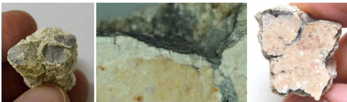
102-104. kép SzfV1 beágyazó habarcs töredéke kékesfekete festéssel.
