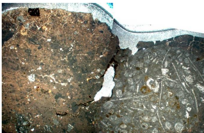
105. kép SzfV1 beágyazó habarcs töredékből készített vékonycsiszolaton jól látható a nagyobb mészkőszemcse töltőanyag.
