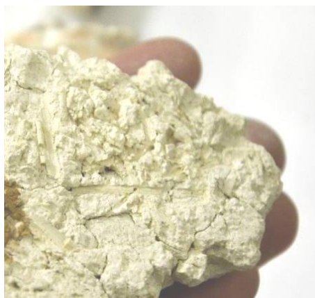
106. kép A székesfehérvári mozaik beágyazó habarcs töredékének hátoldala megőrizte az alapvakolat növényi szálak töltőanyagának lenyomatát.
