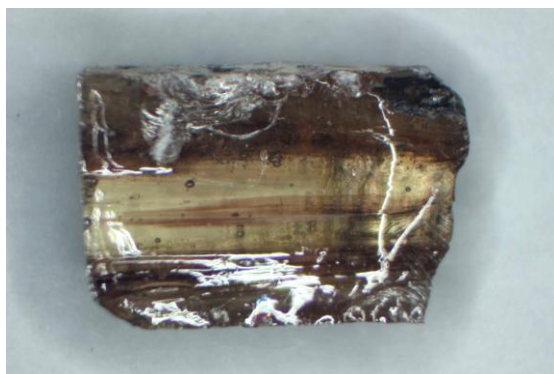
139-142. kép Szfv15. tessera keresztmetszete, és fémbevonatának karaktere.
