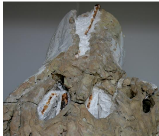
87. kép. A hátoldal részletfelvételei a tisztítás és feltárás közben. A gipszes kiegészítések húzott szög megerősítéseket rejtnek, melyek rozsdásodása térfogat növekedést eredményezett a darabok között.
