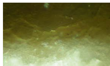
3. kép Normál felvétel: zöldföld réteg olaj kötőanyagban. (objektív nagyítása 20x)
