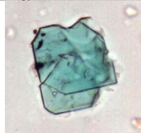
51. kép egyiptomi kék nε= 1.591, nω=1.636 A különbség 0,1 körül van, ezért a szemcse körvonala vékonyan jelentkezik
