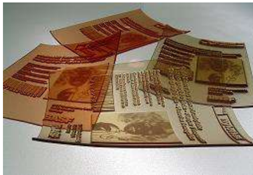
10. ábra Flexónyomtatáshoz használt fotópolimerek
