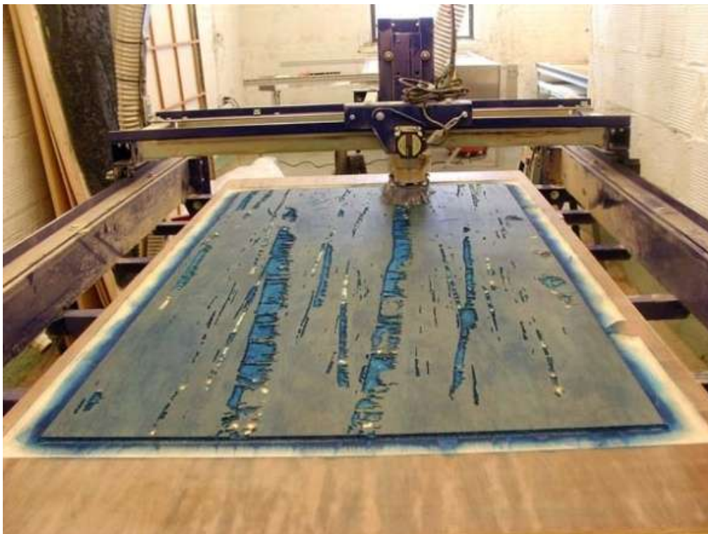
8. ábra 4x8 láb méretű dió rétegelt lemez marása
