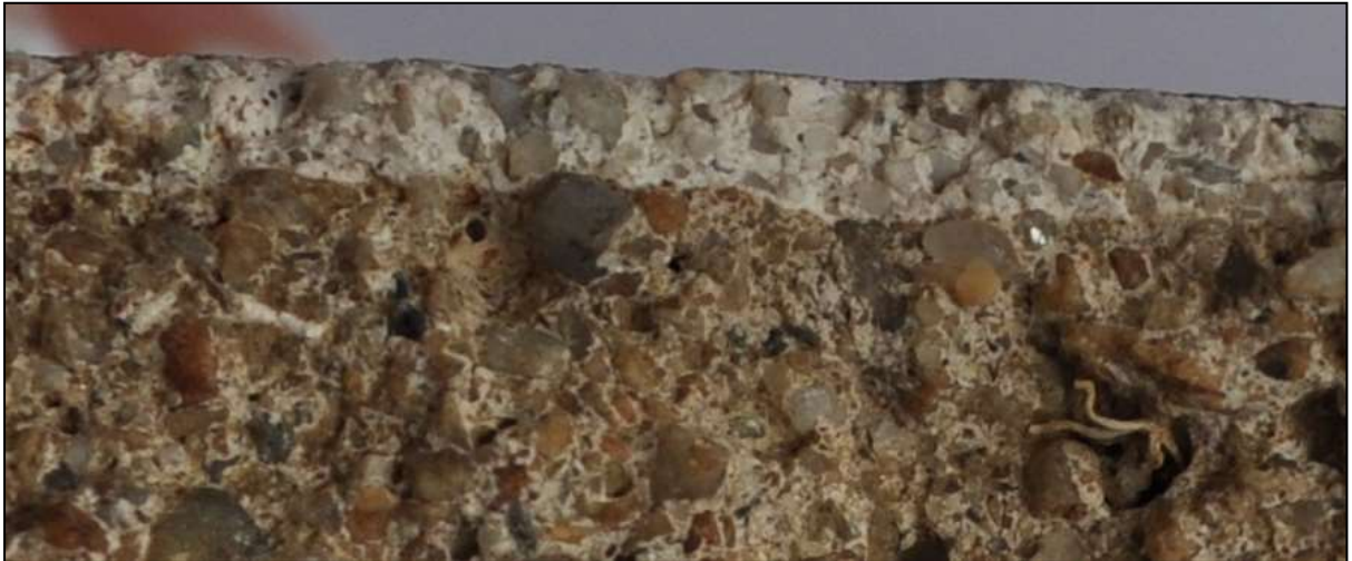
69/a. kép. Intonaco vastagsága 2,5–3 mm.
