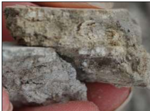
56. kép. Festett intonaco réteg fölött egy újabb arriccio , fölötté újabb intonaco réteg. (Fürdő, nagyméretű terrazzo padlós helyiség falfestményének egy része, Brigetio , Szőny/Dunapart–1-es lelőhely. Foto: H.E.)
