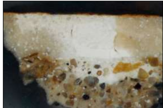
64. kép. Arriccio réteg folyami homok (XCLV épület „páncélos alakot ábrázoló falfestmény” oldalfal, Gorsium (OM, Galambos) Harsányi-Kurovszky 2004b)
