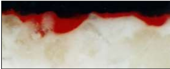
170/b. kép. Keresztmetszet–csiszolat, PLM (obj. 10x) ráső fény (Foto: G.É.)
