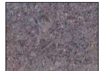
171/c. kép. PLM (obj. 20x) átmenő fény, részben keresztezett polarizátor–analizátor állás. Beágyazó anyag n=1,537. (Foto: G.É.)
