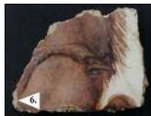
158/c. kép. PLM (obj. 40x) átmenő fény, részben keresztezett polarizátor–analizátor állás. Beágyazó anyag n=1,537. (Foto: H.E.)
