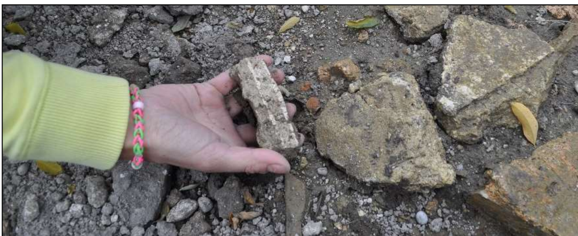
58. kép. Festett intonaco réteg fölött egy újabb arriccio , fölötté újabb intonaco réteg. (Falfestmény, Brigetio , Szőny/Dunapart. Foto: H.E.)
