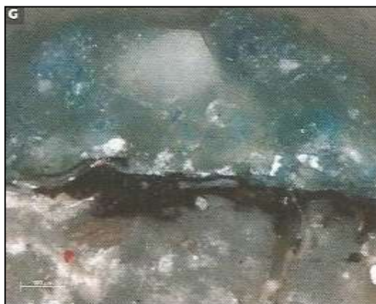
115. kép. Egyiptomi kékkel festett réteg növényi szénfekete aláfestéssel. Keresztmetszet-csiszolat. PLM. (Maasbracht, Hollandia. Megens et al. , 2004, 558.)
