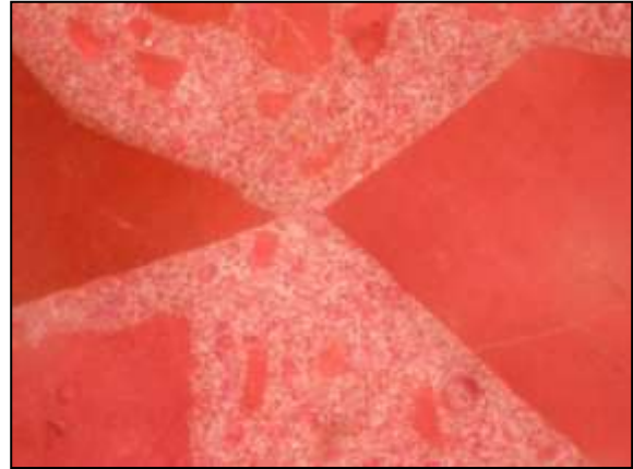
70/b. kép. Alizarin-Szulfonsav-Na reagenssel végzett teszt. A kalcit szemcsék és a mész kötőanyag vörösre színeződött. (Papp 2012, 67., 25. kép)
