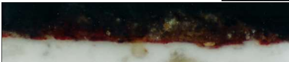
159/b. kép. Keresztmetszet–csiszolat, PLM (obj. 10x) ráeső fény (Foto: G.É.)
