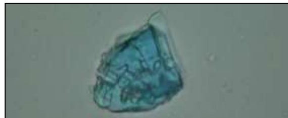
182/c. kép. XLIX. minta. PLM (obj. 40x) átmenő fény. Beágyazó anyag n=1,537. (Foto: H.E.)
