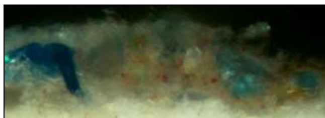
182/d. kép. XLVIII. minta. Keresztmetszet– csiszolat, PLM (obj. 20x) ráeső fény (Foto: H.E.)
