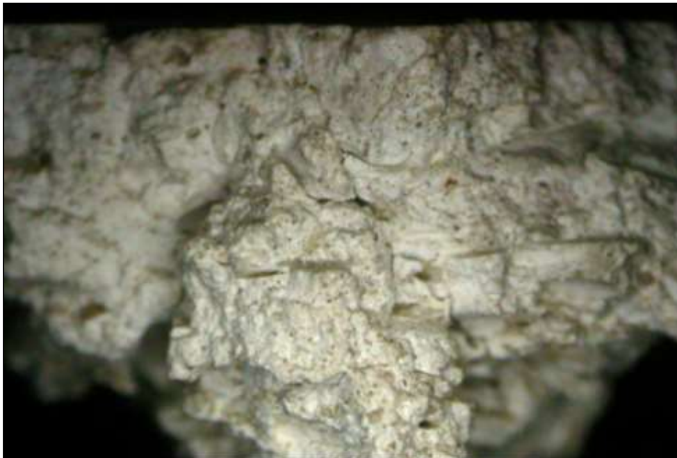
64. kép. Arriccio réteg folyami homok (XCLV épület „páncélos alakot ábrázoló falfestmény” oldalfal, Gorsium (OM, Galambos) Harsányi-Kurovszky 2004b)
