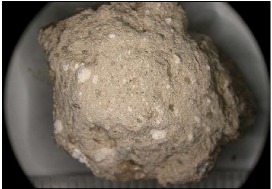
17/c. kép. Mészcsomók a vakolatban. Sztereo-mikroszkópos felvétel (Foto: H.E.)
