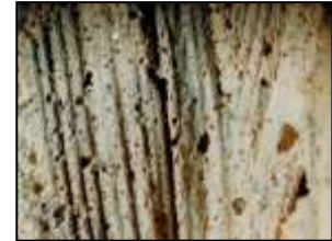
14. kép. Növényi szálak–anyag lenyomata a vakolatban. Sztereomikroszkópos felvétel. ( Gorsium , XL. épület kis helyisége. Foto: G.É.)
