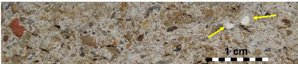
15. kép. Mészcsomók a vakolatban. Töredék a Savariai korai Iseum falfestmény leletéből. (Foto: H.E.)
