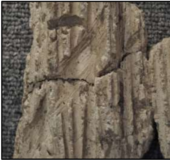
47/a. kép. Kákából álló köteg, és az azt összefogó növényi levelek, valamint a kötegeket egymáshoz rögzítő spárga lenyomata a vakolat hátoldalán. (Foto: H.E.–K.Zs.)
