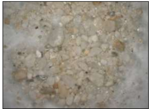
69/c. kép. Intonaco savban nem oldódó összetevői. (Foto: H.E.)
