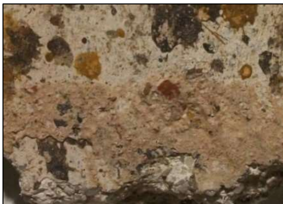
219. kép. Terrazzo habarcsa a már festett vakolatra kötve. (Savaria, korai Iseum falfestménye, lábazat. Foto: H.E.–K.Zs.)
