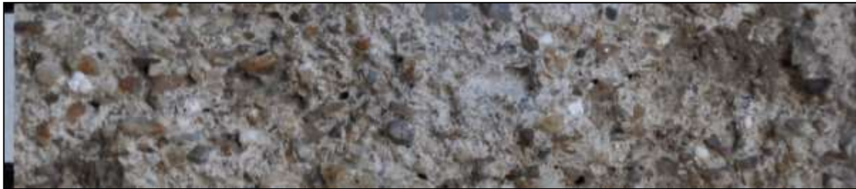
11. kép. Folyami homokkal készült vakolatréteg. Töredék a Savariai, korai Iseum falfestményeletéből. (Foto: H.E.)
