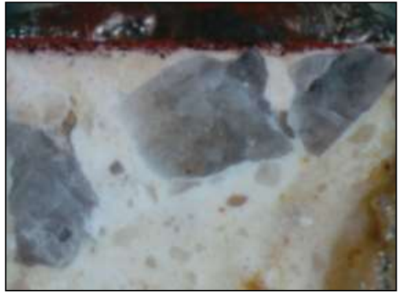
72. kép. Kalcit szemcsék az intonacóban . („Szily János utcai” falfestmény, Savaria . OM Galambos. Restaurálási dokumentáció, Kurovszky 2006)
