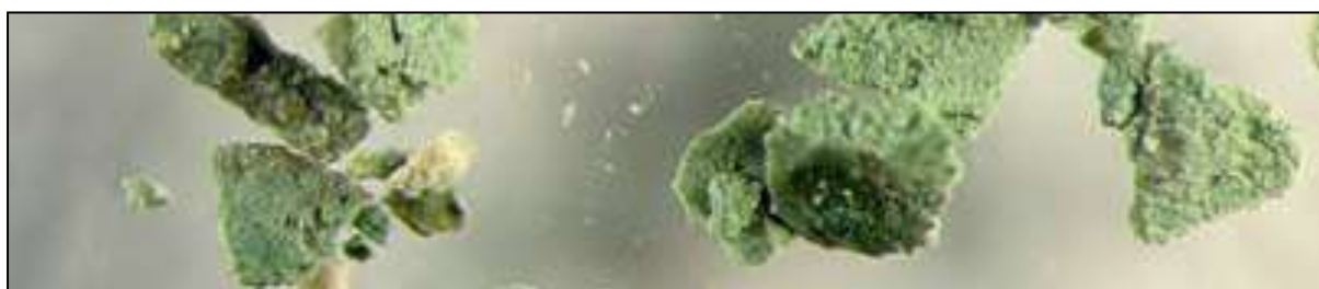
122. kép. Zöldföld szemcsék falfestményből PLM. (Strasbourg, Franciaország. Pagès-Camagna–Laval 2012, 132 Fig .4.)
