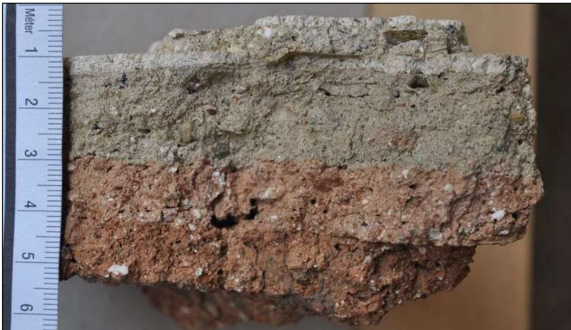
68. kép. Alsó két arriccio réteg töltőanyaga cserép- vagy téglaoőrlemény. (Szöny/Duna part – 1-es lelőhely. Str. 11. Leletmentés, 2014. Foto: H.E.)
