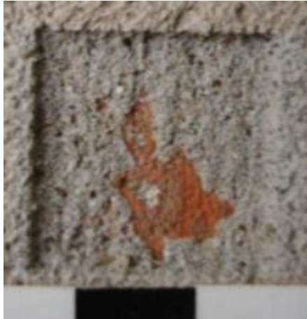
63. kép: B_1_2 minta lézerrel tisztított területe
