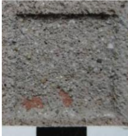
82. kép: BC_1_1 minta lézerrel tisztított területe
