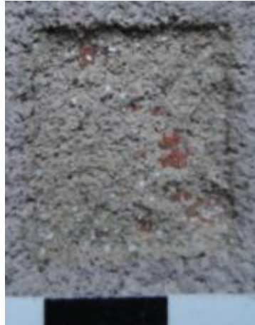
140. kép: IC_4_2 minta lézerrel tisztított területe
