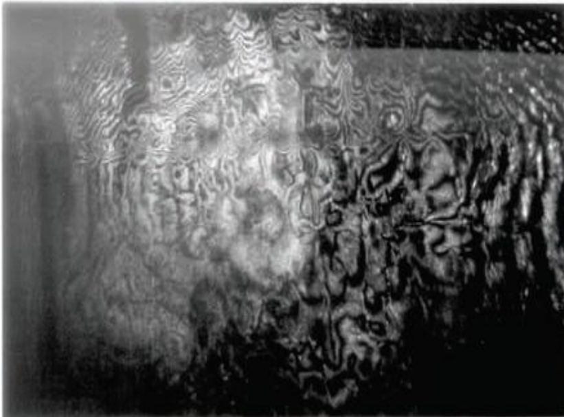
15. kép: El Greco: Mária gyermekével című kép közepső részének holografikus interferomtria képe
