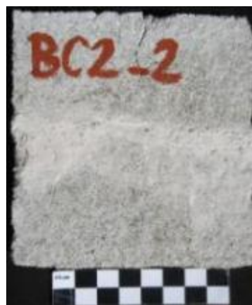
188. kép: BC_2_2 minta lézeres tisztítás előtt, hátoldal
