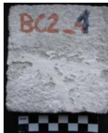
178. kép: BC_2_1 minta lézeres tisztítás előtt, hátoldal
