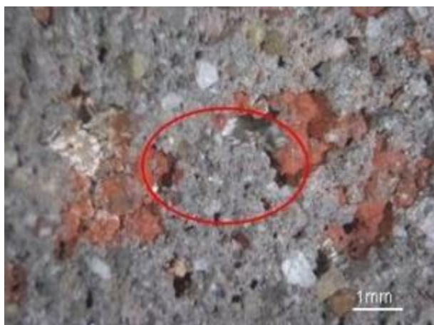
28. kép: I_1_3 minta lézeres tisztítás után. Optikai mikroszkópos fotó a lézerrel tisztított területről, részlet. A jelölt területen a szennyeződés mintha már elvált volna a festékrétegtől, de nem pattant le. Ez lehet az oka a 26. és 27. képeken látható elváltozásnak.
