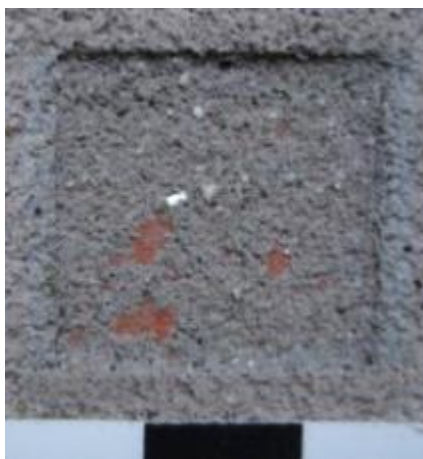
38. kép: IC_1_2 minta, lézerrel tisztított területe
