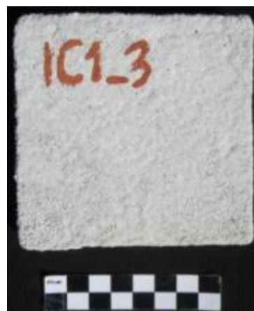
47. kép: IC_1_3 minta, lézeres tisztítás után, hátoldal
