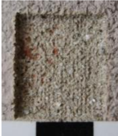
163. kép: B_2_2 minta lézerrel tisztított területe
