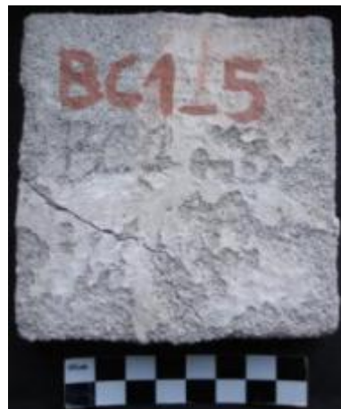
205. kép: A BC_2_3 a lézeres tisztítás és a DHSPI megfigyelés után eltört A lézeres tisztítás és DHSPI mérések előtt a mintát átneveztem BC_1_5-ről BC_2_3-ra
