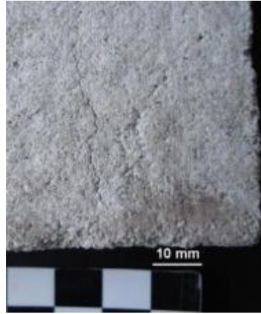
25. kép: I_1_3 minta lézeres tisztítás előtt. A minta hátoldalán látható határozott repedés lehet az oka a csíkrendszerben megfigyelhető deformitásnak
