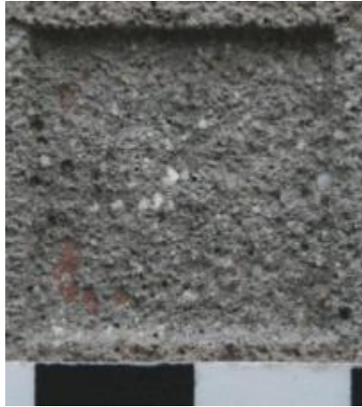
89. kép: BC_1_2 minta lézerrel tisztított területe
