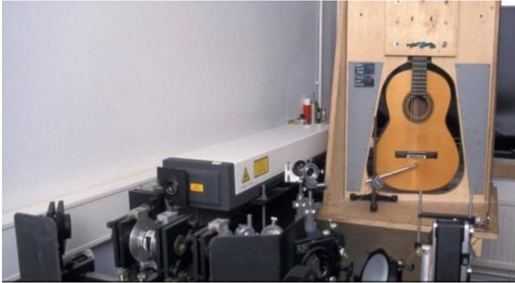
9. kép: Holografikus interferogram felvételére szolgáló kísérleti elrendezés [59]
