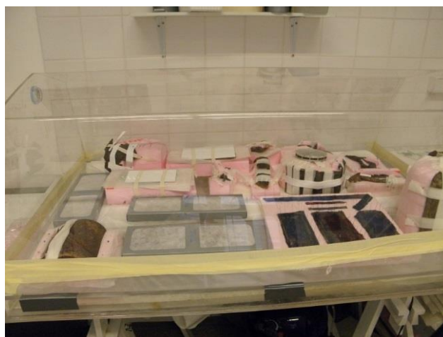
20. kép Pro-Sorb kazettákkal kondicionált párabúra, a formára igazított tétel utókezelése 45–50% RH-n
