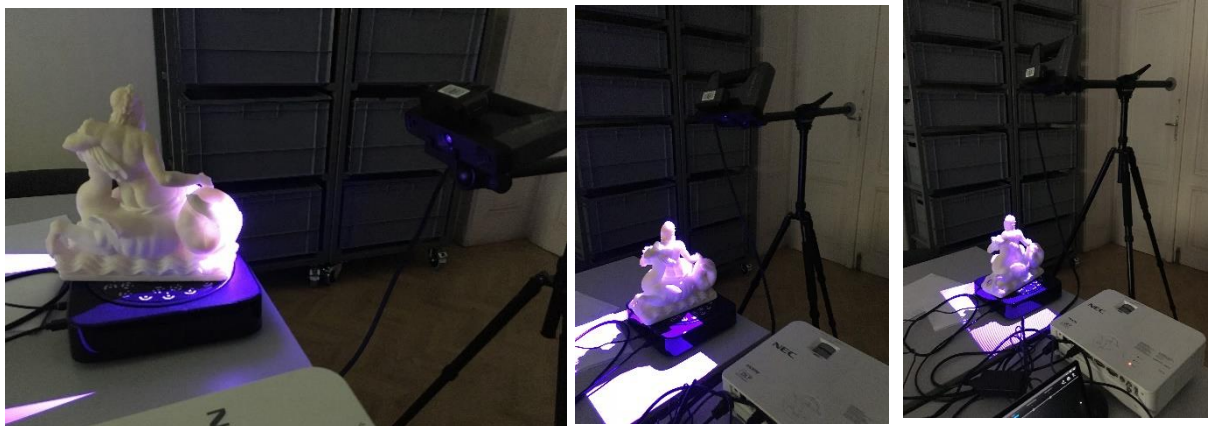
72-74. kép A Poszeidón szobor szkennelése különböző szögekből.
