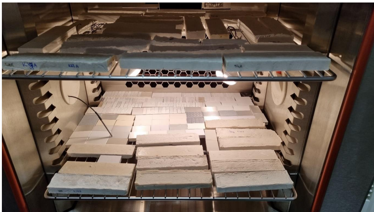
38. kép Habarcsos és 3D nyomtatott mintatestek az Excal Climats klímakamrában.
