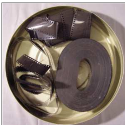
53. kép: Merevvé vált cellulóz-acetát filmtekercs
