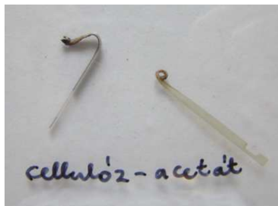
46. kép: A cellulóz-acetát filmminta meggyújtását követően a láng kialszik
