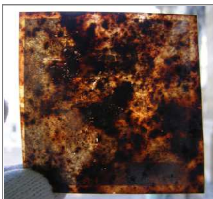
51-52. kép: A savas bomlástermékek károsítják az emulziós réteget
