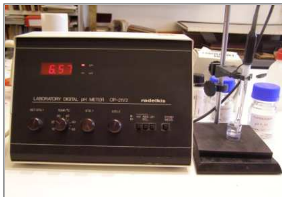
76-77. kép: Az áztatóközeg üvegelektrodás pH-mérése
