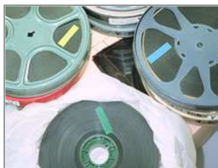
56-57. kép: Brómkrezol-zöld alapú A-D testcsík és alkalmazása
