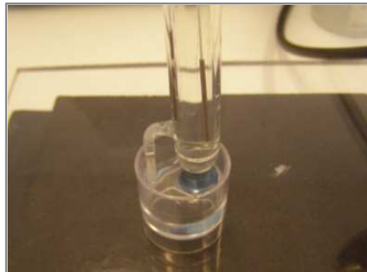
76-77. kép: Az áztatóközeg üvegelektrodás pH-mérése
