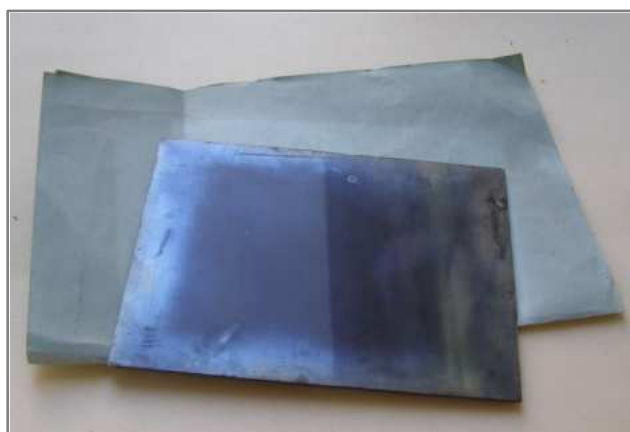
43. kép: Savas kémhatású papír okozta ezüstkiválás az üveglemez emulziós oldalán
