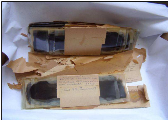
62-65. kép: A cellulóz-nitrát film lebomlásának negyedik stádiuma
