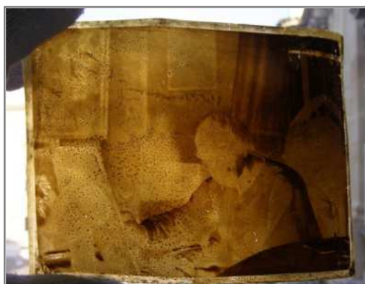
51-52. kép: A savas bomlástermékek károsítják az emulziós réteget
