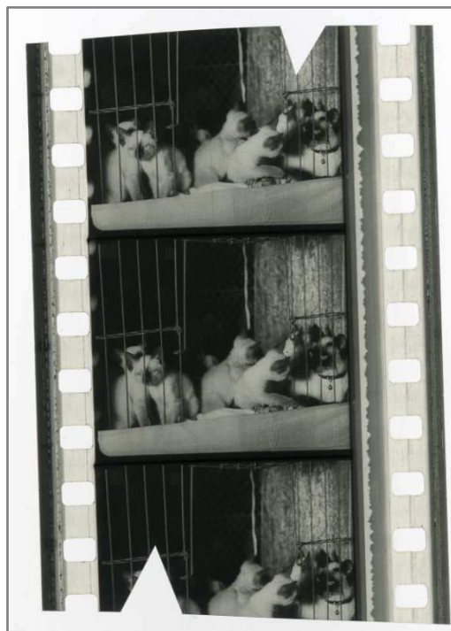
84. kép: Az ammónium-hidroxid/desztyillált víz 1/60-as hígítású oldatának gőzterében 24 óráig kezelt minta (800 dpi)
