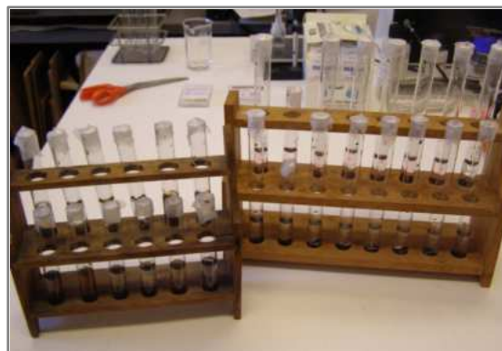
74-75. kép: A filmminták előkészítése pH-méréshez
