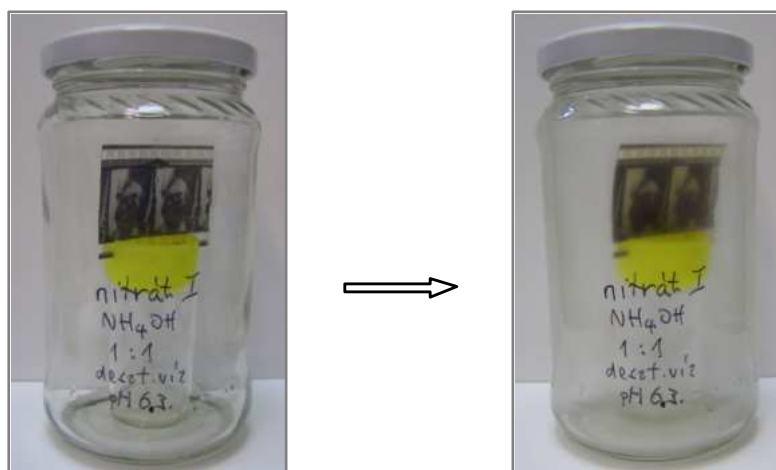
80. kép: A kezelés során telített gőztér alakul ki, a páralecsapódás megfigyelhető az edény falán
