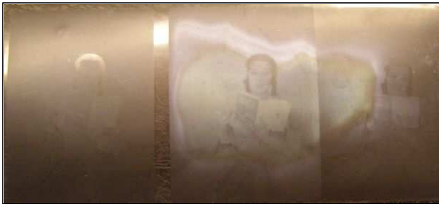
68. kép: Ezüstkiválás és foltszerű, barna elszíneződés a tekercs film emulziós oldalán
