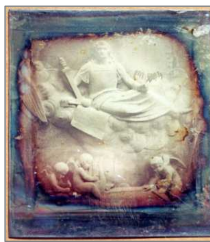
14-15. kép: Korróziós réteg a dagerrotíp lemezek felületén
