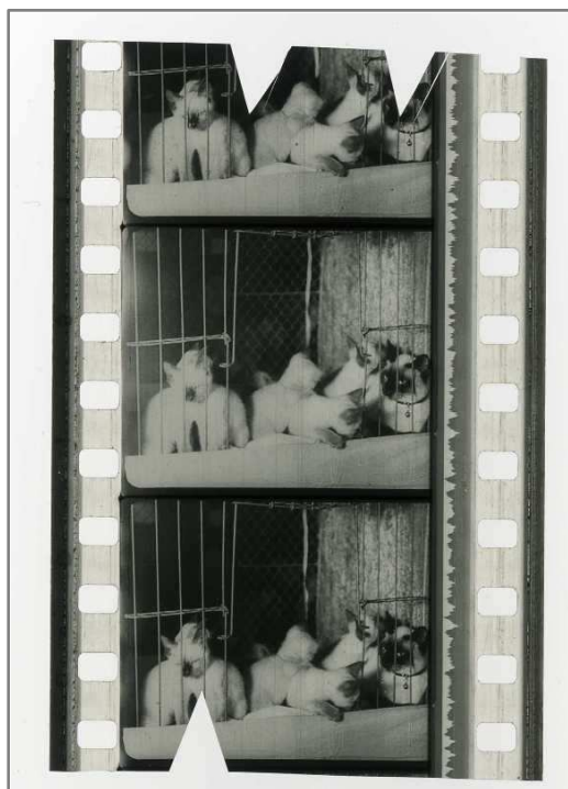
85. kép: Cellulóz-nitrát (CN I) filmminta kezelés előtt (800 dpi)
