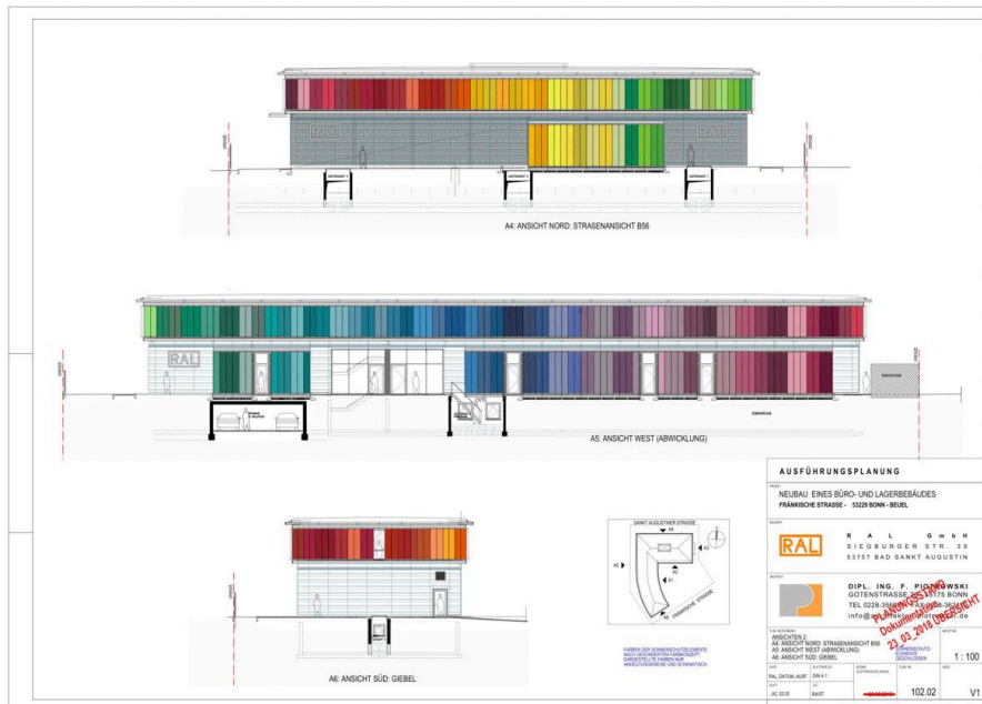
11. A bonni főépület metszetrajza a színes napellenzők kiosztásával
