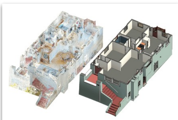
[53] Scan to BIM folyamat két végpontja: a nyers pontfelhő és az ez alapján rekonstruált 3D modell
