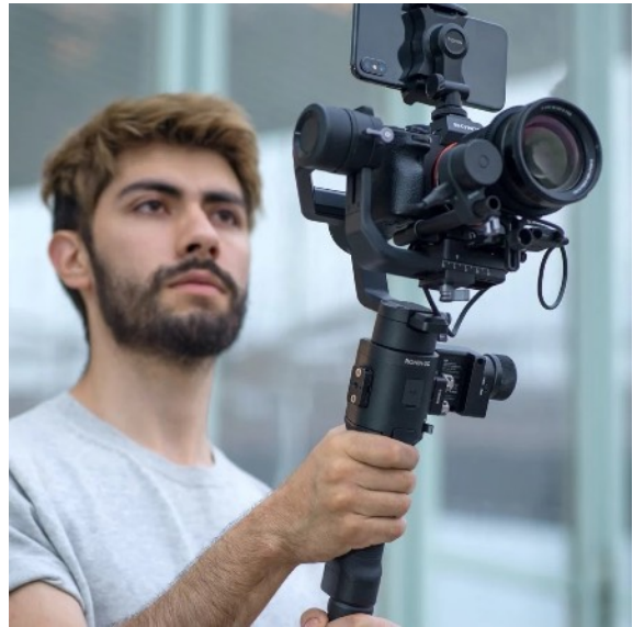
[26] Gimbal – kamera stabilizátor szélesebb felhasználói körnek (DJI Ronin-SC)
