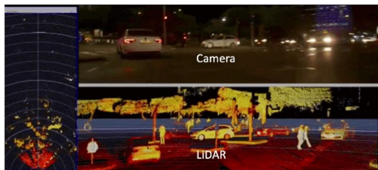
[60] Autókban alkalmazott LIDAR szenzor képe (alul), a hagyományos kameraképpel összevetésben (felül), valamint a lézer által detektált téri adatok felülnézeti vizualizációja (balra)
