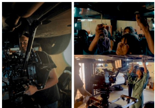
[36] Az objektív újabb, periszkóp-szerű változata, mely új nézőpontokhoz enged fizikai hozzáférést
