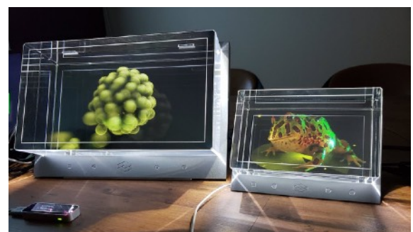
[79] A Looking Glass Factory lightfield technológiát alkalmazó holografikus kijelzői
