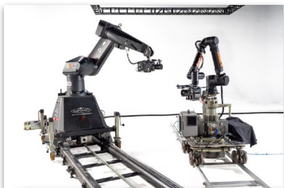
[24] Kameramozgás kontrollálására optimalizált robotkarok (MRMC Bolt)
