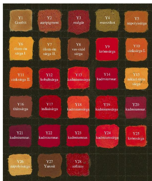
82. ábra – A sárga pigmentmezőkről készült VIS-R_VIS balra; ultraibolya false-color kép jobbra; Phase One IXH, 72 mm, f/8.0, 1/2 sec VIS, 8 sec UVR, ISO 50; Goethit, Y2 auripigment, Y3 realgár, Y4 masszikot, Y5 nápolyi sárga, Y6 ólom-ón sárga I., Y7 ólom-ón sárga II., Y8 mesterséges vas-oxid sárga, Y9 krómsárga, Y10 cinksárga I., Y11 cinksárga II., Y13 kadmiumsárga, Y14 kadmium sárga, Y15 nikkel-titán sárga, Y16 titán-sárga, Y17 indiai sárga, Y18-Y24 kadmium sárgák, Y25 krómsárga, Y26 nápolyi sárga, Y27 Jarosit. Forrás: saját felvételek
