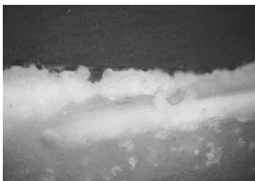
109. ábra - Próba felvétel a tesztelési folyamat során egy vörös festékrétegből vett minta keresztmetszet csiszolatáról, IR-IR_830-1000. Forrás: saját felvétel
