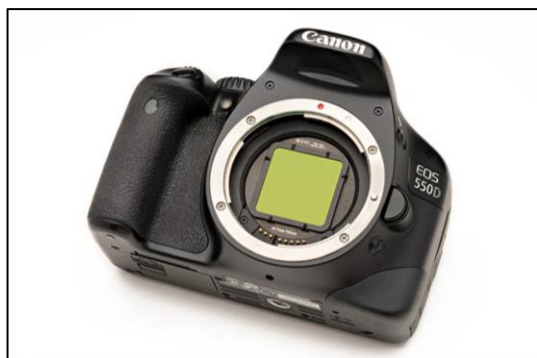
106. ábra – Egy Canon APSC vázba beillesztett szűrő. Forrás: https://www.stcoptics.com/collections/clip-filters?pf_t_camera_type=Canon
