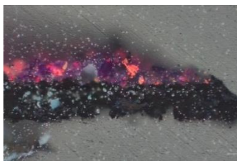
225. ábra - A BL2-es szektorból vett minta keresztmetszet csi-szolatának polarizációs mikroszkópos felvétele, VIS-R_VIS (10x okulár, 20x objektív). Forrás: saját felvétel
