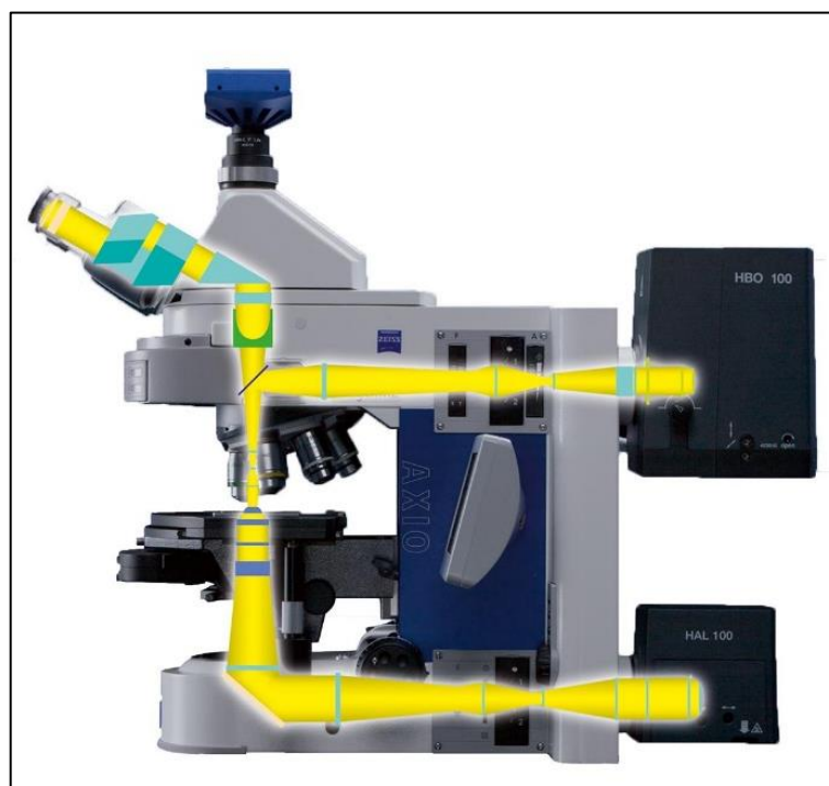
103. ábra - A Zeiss Axio Imager rendszerű polarizációs optikai mikroszkóp fényútjainak egyszerűsített ábrája (ráeső átmenőmenőfényes vizsgálati típus egyaránt feltüntetve) Forrás: www.zeiss.com
