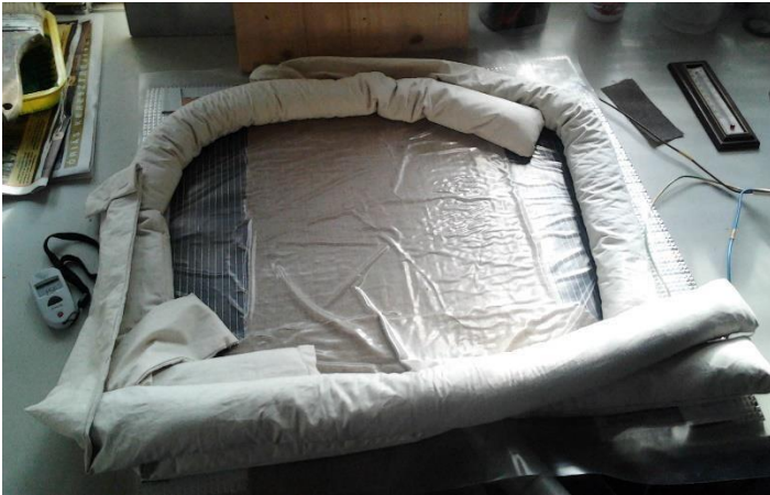
Az infrafilm tesztelése, és a porszívó vákuumerősségének próbaműködése
